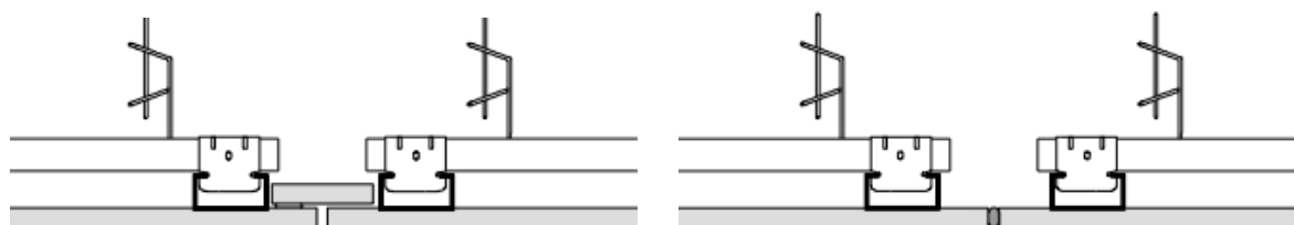
Rys. 3.60. Przykłady złącz kompensacyjnych suchej zabudowy. Źródło: "Manuale dei sistemi a secco" Gyproc - www.gyproc.it
