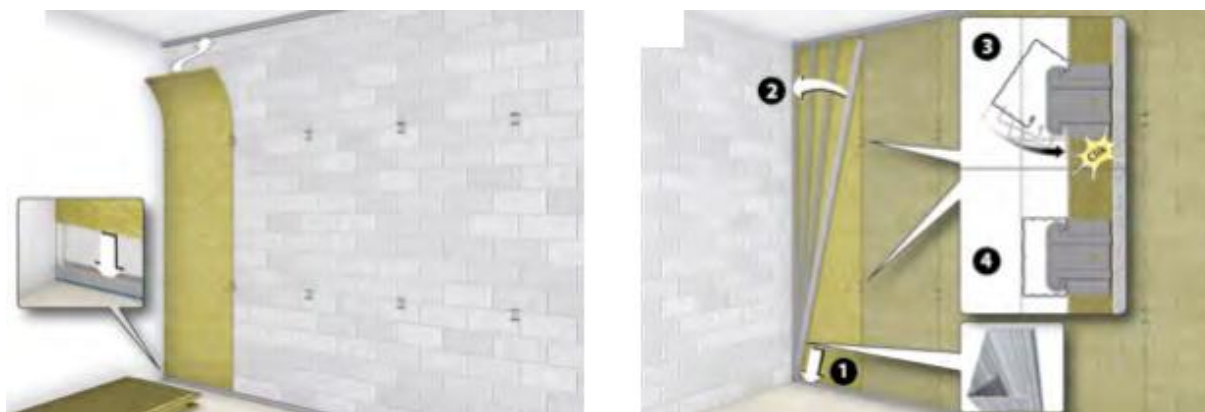
Rys. 3.43. Przykład montażu wsporników pionowych. Źródło: “Manuale Tecnico: Soluzioni per interni” – GYPSOTECH - www.fassabortolo.it
