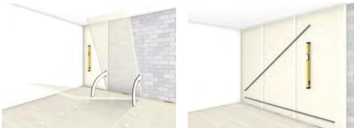
Rys. 3.38. Przykład układania obudowy ścian. Źródło: "Manuale Tecnico: Soluzioni per interni" GYPSOTECH - www.fassabortolo.it
