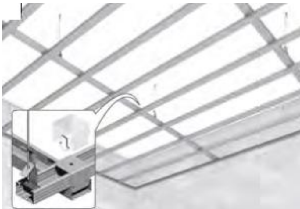
Rys. 3.56. Przykład montażu niskich sufitów podwieszonych. Źródło: “Manuale Tecnico: Soluzioni per interni” – GYPSOTECH - www.fassabortolo.it
