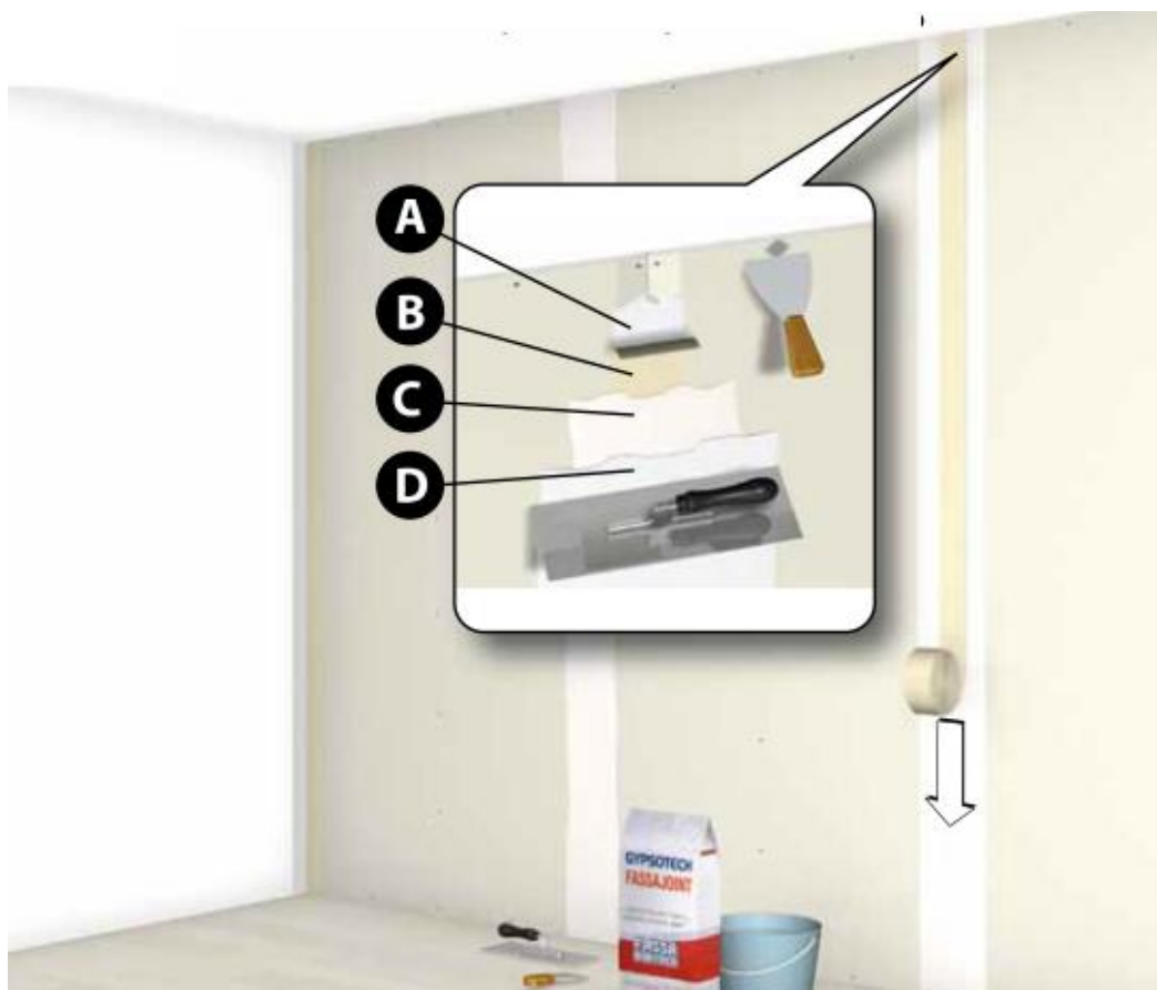
Rys. 3.61. Przykład wykonywania złącz płyt obudowy.
