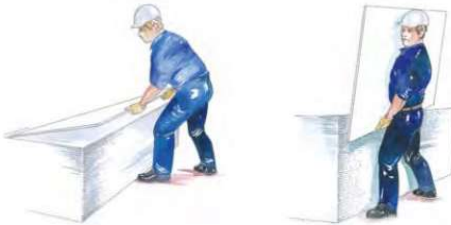
Pav. 2.4. Plokščių perkėlimas: Vienas žmogus
