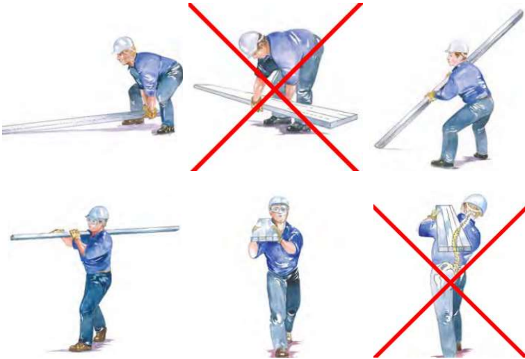
Pav. 2.3. Karkaso elementų perkėlimas – Vienas žmogus
