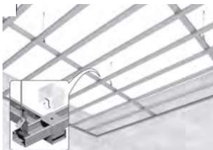
Pav. 3.56. Nuleistų pakabinamų lubų įrengimo pavyzdys. Šaltinis: “Manuale Tecnico: Soluzioni per interni” – GYPSOTECH - www.fassabortolo.it
