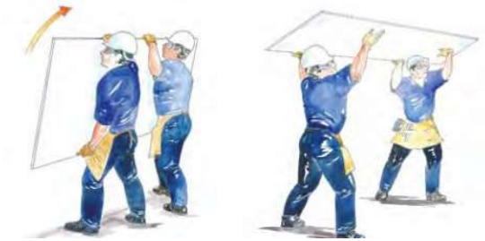
Pav. 2.7. Gipskartonio plokštės pakėlimas (įskaitant lubas) – Dviejų žmonių atliekama operacija
