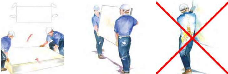
Pav. 2.5. Plokščių perkėlimas: du žmonės
