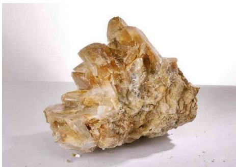
3.1 pav. Gipso mineralo pavyzdys. Šaltinis: Mokymo vadovas - I sistemi a secco a base gesso – Assogesso
