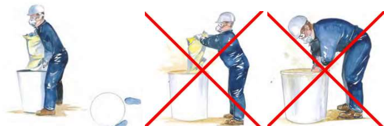
Pav. 2.2. Maišymas – Maišo supylimas į maišymo indą
