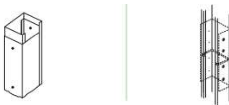
Pav. 3.28. Vertikalių profilių jungimo pavyzdžiai. Šaltinis: „Manuale dei sistemi a secco” – Gyproc - www.gyproc.it
