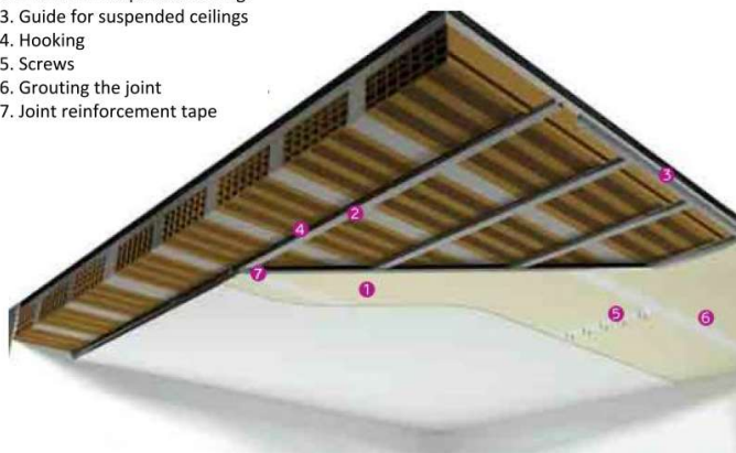
Figure 3.22. Pakabinamų lubų pavyzdys. Šaltinis: “Manuale del Posatore” – Siniat – www.siniat.it
