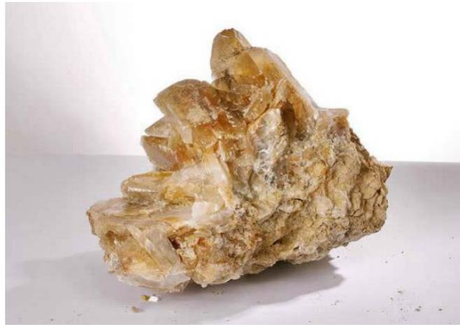
Fig. 3.1 Esempio di un pezzo di gesso. Fonte: corso di formazione- I sistemi a secco a base gesso – Assogesso
