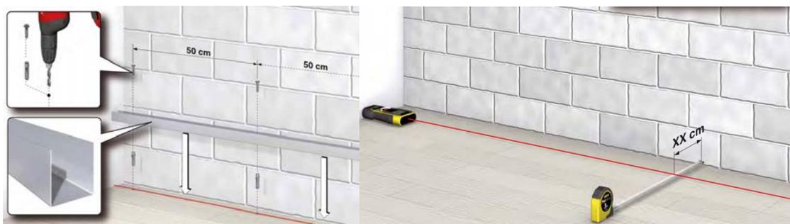
Fig. 3.39 - Esempio di utilizzo di tappi con una sottostruttura metallica Fonte: “Manuale Tecnico: Soluzioni per interni” – GYPSOTECH - [www.fassabortolo.it](http://www.fassabortolo.it)
