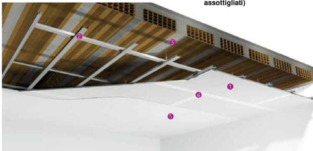
Fig. 3.22 – Esempio di controsoffitto in sospensione Source: “Manuale del Posatore” – Siniat –www.siniat.it
