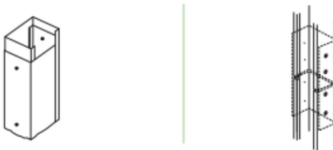
Fig. 3.28 - Esempio di soluzione utilizzata per il collegamento di profili verticali Source: "Manuale dei sistemi a secco" – Gyproc - [www.gyproc.it](http://www.gyproc.it)
