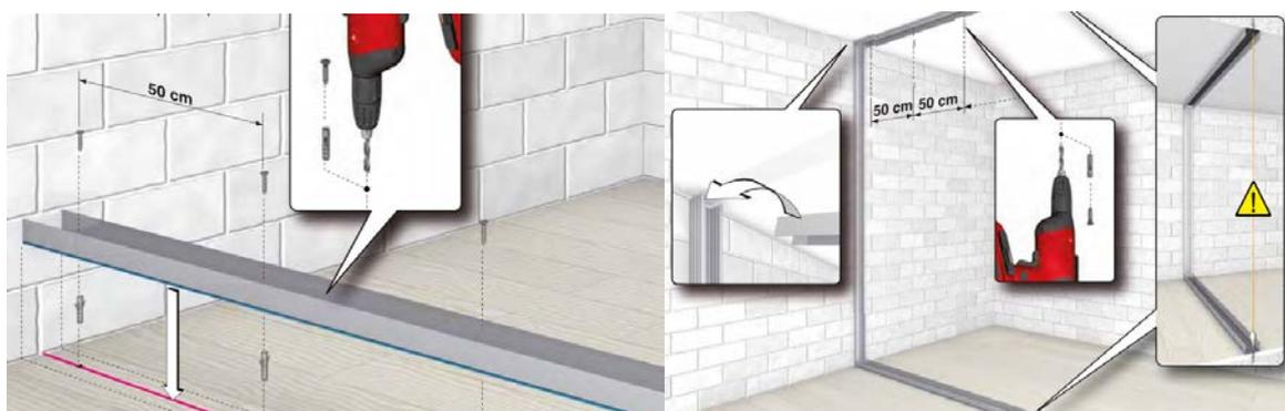
Fig. 3.27 - Esempio di montaggio di profili in acciaio Fonte: "Manuale Tecnico: Soluzioni per interni" – GYPSOTECH - [www.fassabortolo.it](http://www.fassabortolo.it)
