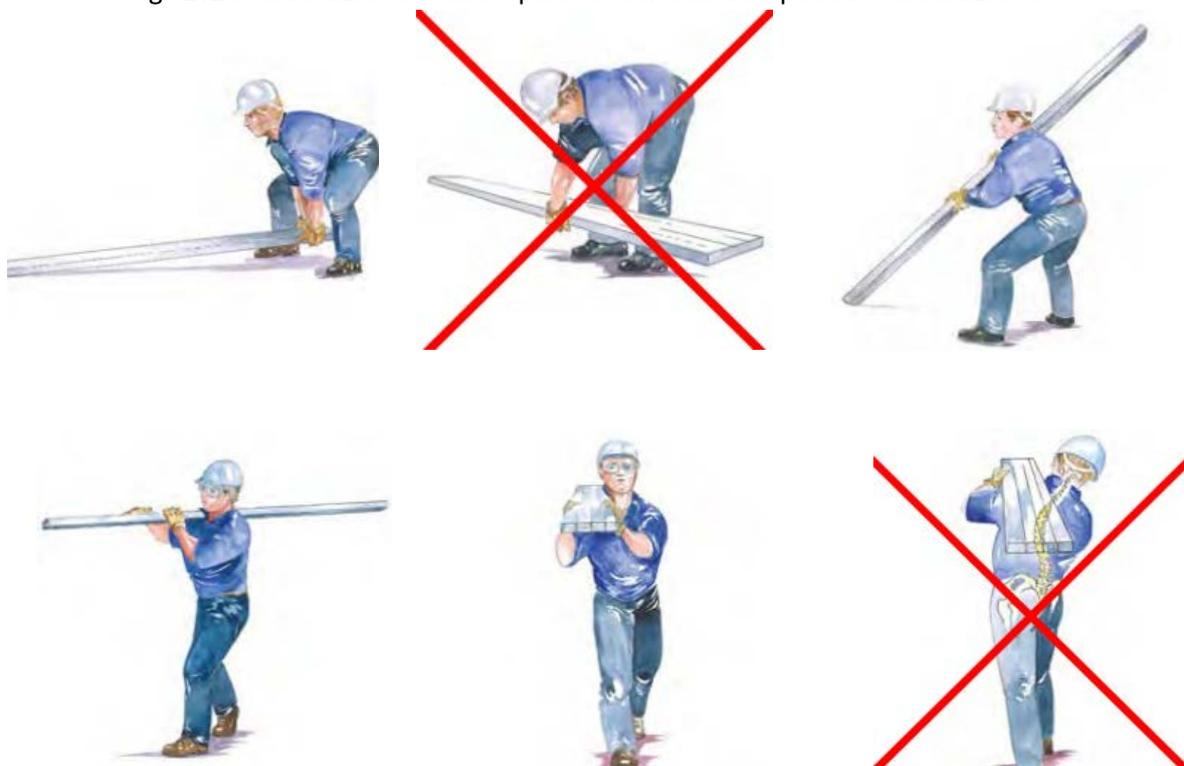
Fig. 2.3 Movimentare i profilati metallici - 1 persona
