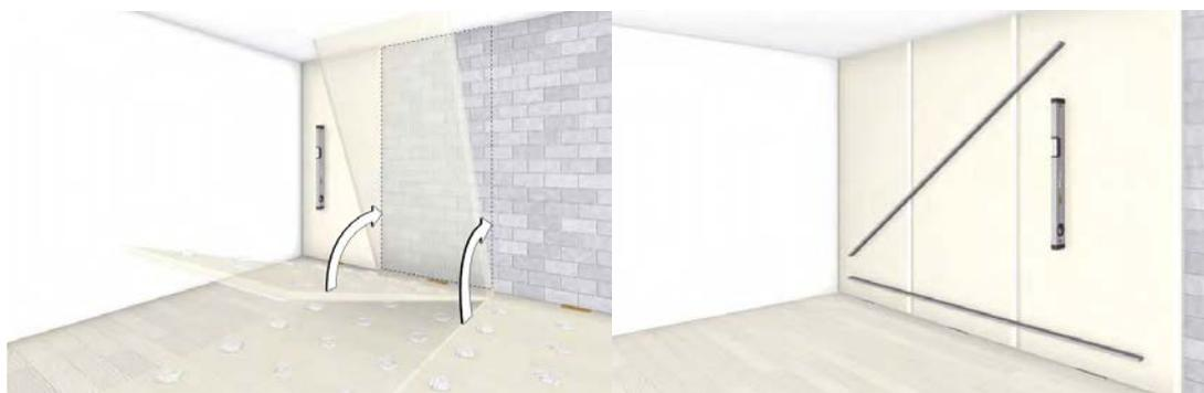
Fig. 3.38 - Esempio di posa di un involucro a parete Fonte: “Manuale Tecnico: Soluzioni per interni” – GYPSOTECH - [www.fassabortolo.it](http://www.fassabortolo.it)
