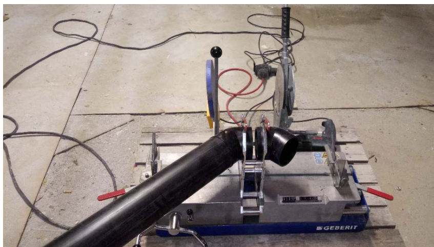
Fig. 3.84 Foto Saldatrice per saldature testa a testa, dotata di piano meccanico e piastra riscaldante (immagine di proprietà dell'autore)
