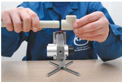
Fig. 3.14 Foto Unire il tubo con il raccordo a gomito nel sistema in PP
