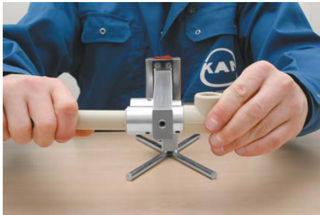
Fig. 3.13 Foto Saldatura del tubo con il raccordo a gomito nel sistema in PP
