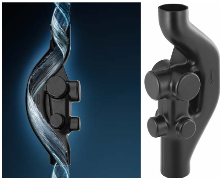
Fig. 3.88 Tra i numerosi accessori, come scarichi, pozzetti, rami orizzontali e raccordi di sistema, Geberit offre anche un unico sistema di raccordi monolitico per il collegamento dei vari livelli del sistema fognario dalle strutture sanitarie, chiamato Sovent. Questo elemento garantisce un notevole risparmio di tempo nell'installazione dei raiser e ne aumenta la portata ammissibile rispetto alla soluzione basata su accoppiatori tradizionali con lo stesso diametro.
