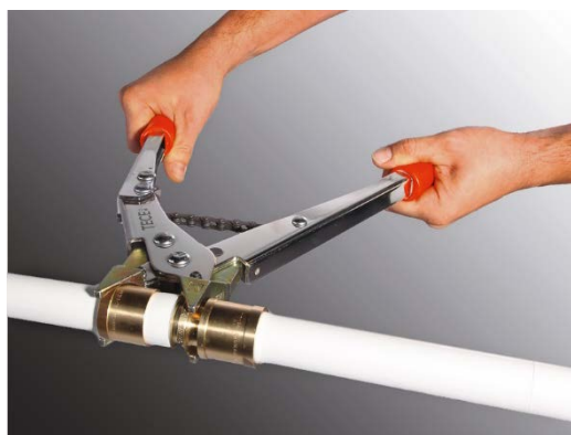
Fig. 3.42 Foto Scorrimento del manicotto per stabilizzare il raccordo
