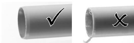
Fig. 3.46 (3) Verifica della corretta smussatura e calibratura del tubo
