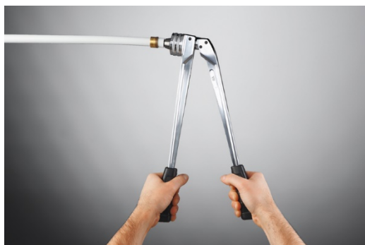
Fig. 3.41 Foto Dilatazione di un tubo con apposito strumento TECEflex
