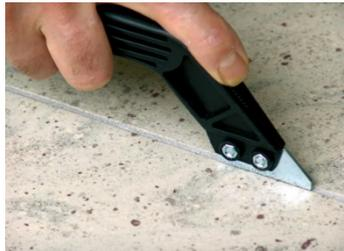
Fig. 5.15. Strumento per la pulizia dei giunti e la rimozione delle croci
