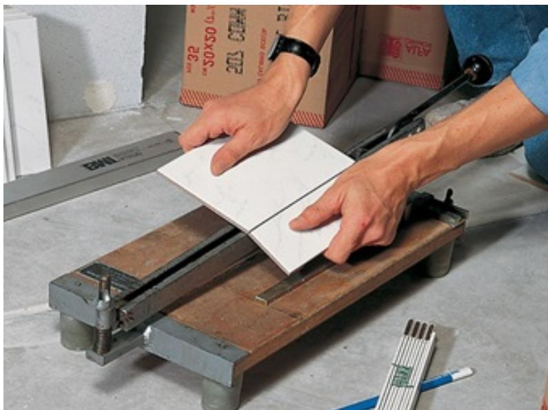
Fig. 7.29. Utilizzo di una macchina da taglio per piastrelle
