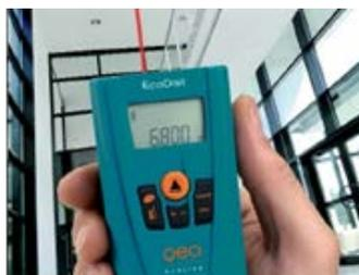
Fig. 5.5. Calibro ad ultrasuoni per misurare le distanze, calcolare le aree della stanza
