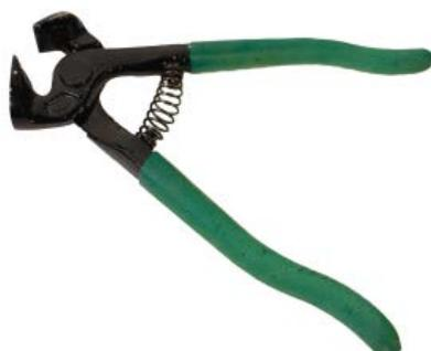
Fig. 5.20. Pinze per la rottura di piastrelle
