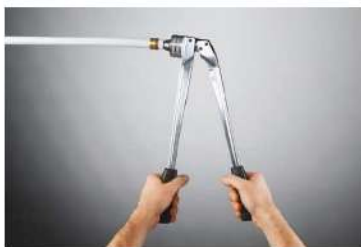
Pav.. 3.41. Vamzdžio kalibravimas su TECEflex įrankiu.
