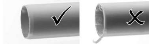
3.46 pav. (3) Patikrinkite, ar vamzdis buvo tinkamai kalibruotas ir nuvalytos vamzdžio atplaišos.
