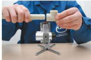
3.14 pav. Vamzdžio sujungimas su jungtimi (alkūne) PP sistemoje
