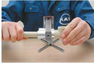
3.13 pav. Vamzdžio ir jungiamųjų detalių (alkūnių) suvirinimas PP sistemoje
