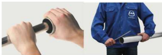
3.25 pav. Plieninių vamzdžių briaunų apšlifavimas po pjovimo
