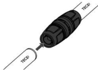
3.47 pav. (4) Vamzdžio įstumimas.
