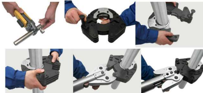
3.29 pav. Presavimas įvairaus skersmens jungčių
