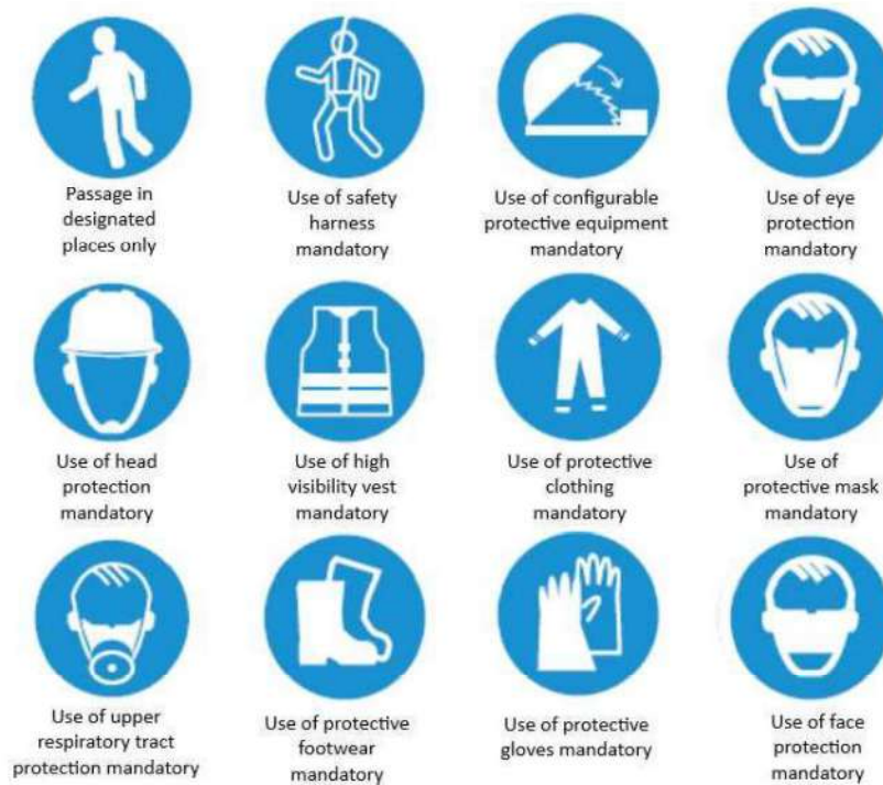
2.9 pav. Statybos aikštelėje privalomi ženklai.
