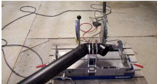
3.84 pav. Įranga vamzdžių galų suvirinimui, kartu su mechanine plokštuma ir kaitinimo plokšte.
