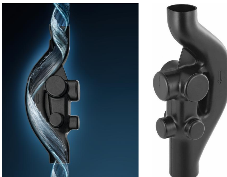
Rys. 3.88. Wśród wielu akcesoriów jak wpusty, czyszczaki, podejścia i kształtki systemowe firma Geberit proponuje unikalny system monolitycznej kształtki do podłączenia poziomów kanalizacyjnych z sanitariatów o nazwie sovent. Element ten zapewnia dużą oszczędność czasu przy montażu pionów oraz zwiększa dopuszczalną przepustowość pionów w stosunku do rozwiązania z kształtek tradycyjnych o tej samej średnicy
