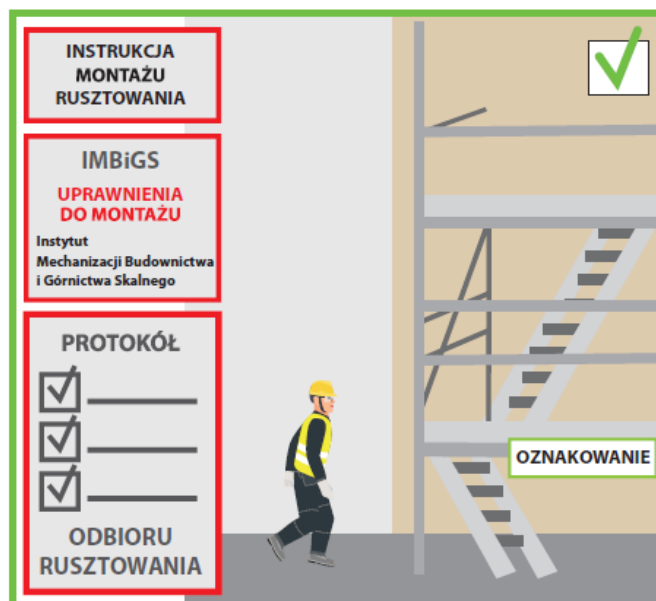
Rys. 2.5. Prawidłowe stosowanie rusztowań.
