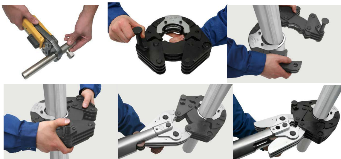
Rys. 3.29. Czynność zaprasowywania połączeń różnych średnic
