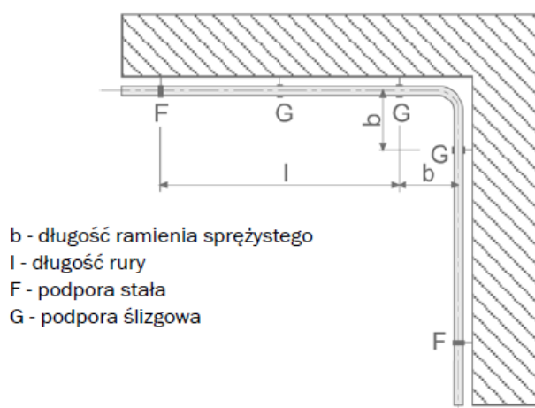
Rys. 3.55. Kompensacja wydłużenia termicznego poprzez zmianę kierunku układania instalacji to tzw. kompensacja naturalna / kątowa.
