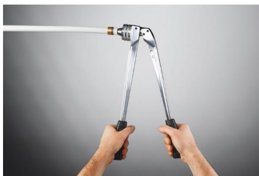
Rys. 3.41. Rozpęcznianie rury za pomocą narzędzia dedykowanego tece flx.
