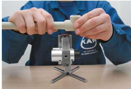
Rys. 3.15. Unieruchomienie rury z kolanem w systemie PP
