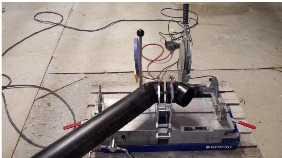
Rys. 3.84. Zgrzewarka do zgrzewania doczołowego uzbrojona w mechaniczny strug i płytę grzewczą (źródło własne)
