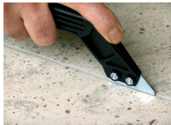
Rys. 5.15. Skrobak do fug
