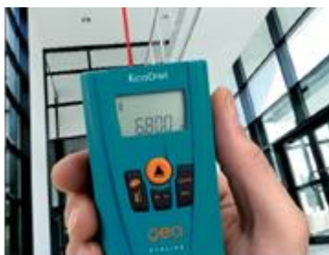
Rys. 5.5. Dalmierz ultradźwiękowy - do pomiaru odległości, obliczania powierzchni pomieszczenia
