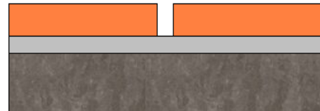
Szerokie niewypełnione połączenia
