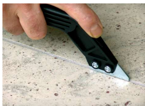
Įrankis siūlių valymui ir kryžiukų šalinimui iš siūlės
